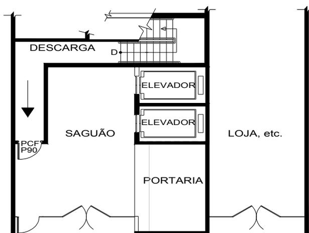
Figura 18 – Descarga através de *hall* térreo não enclausurado
