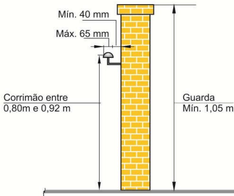
Figura 14 – Dimensões de guardas e corrimãos
