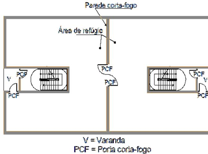
Figura 17 – Desenho esquemático da área de refúgio
