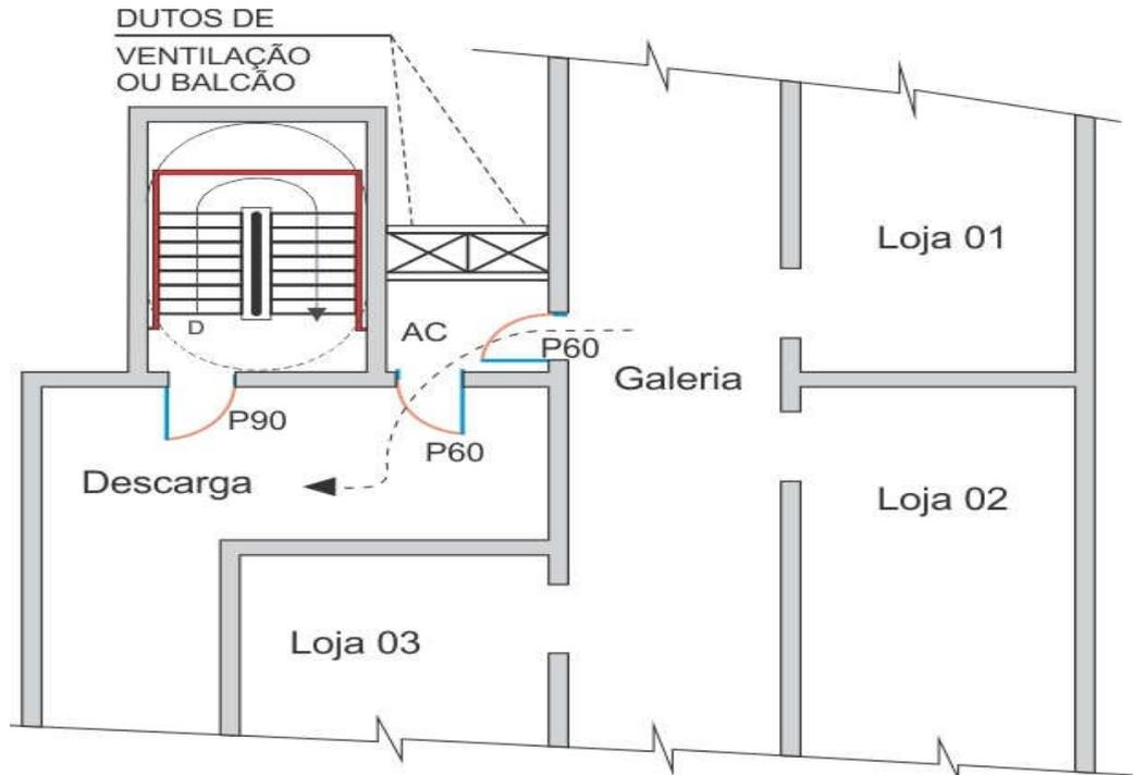
Figura 20 - Acesso de galeria comercial à descarga
