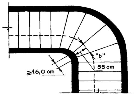
Figura 5 – Escada com lanços curvos e degraus balanceados
