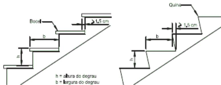
Figura 4 – Altura e largura dos degraus
