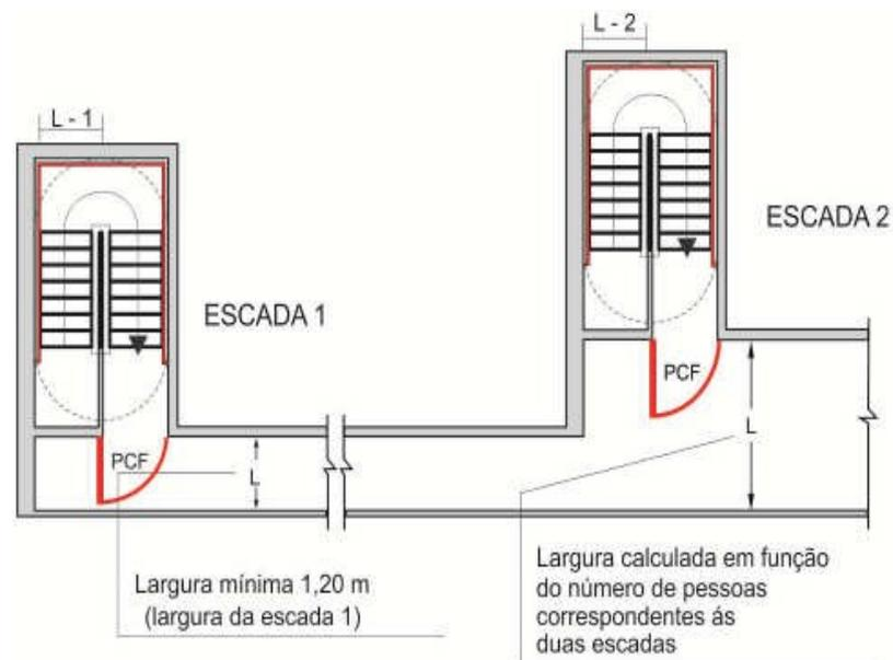
Figura 19 – Dimensionamento de corredores de descarga
