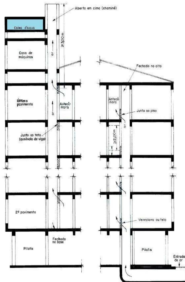
Figura 10 – Exemplos de dutos de ventilação
