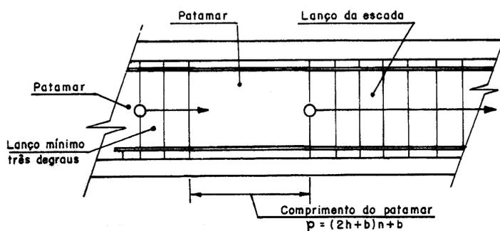
Figura 6 – Lanço mínimo e comprimento de patamar
